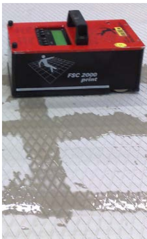
Betonastryk af GIAN® 1 vaffel bliver testet våd med FSC 2000 print
