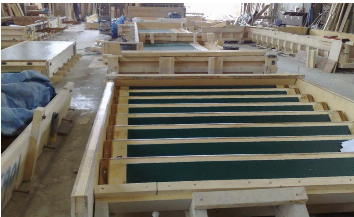
Eksempler på betonforme af træ med deri en GIAN® fastlimet strukturmåtte.
